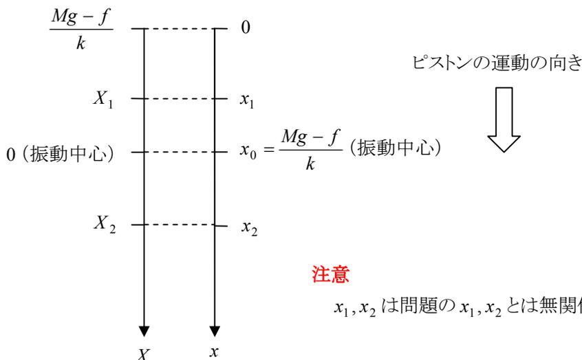
ピストンが下向き ( $x_1$  から  $x_2$ ) に移動する間の系の力学的エネルギーと動摩擦力の仕事の関係
