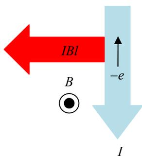
電子が受けるローレンツ力  $evB$  の向きと電磁力の向きは同じである。
